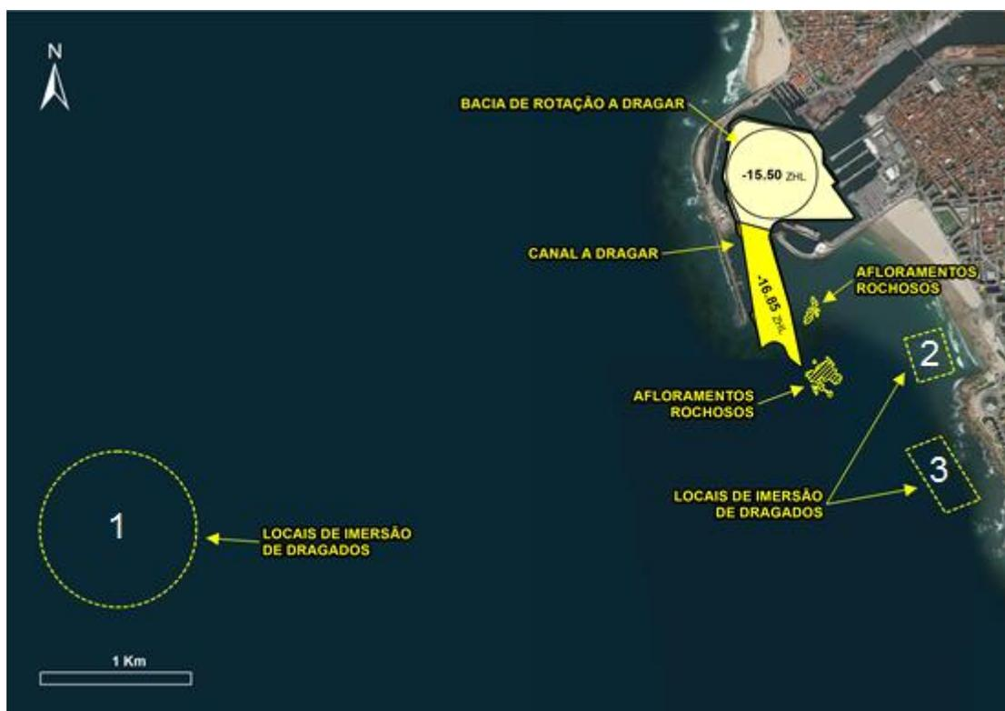
Figura 21 – Indicação esquemática da área de intervenção do projeto e locais de imersão de dragados
